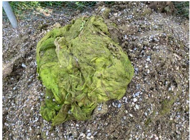
*Abbildung 19: Austräge bei der Absaugung der Oberfläche des Pflanzensandfilters: Algen-Sand-Kies gemisch, 08.07.2021*
