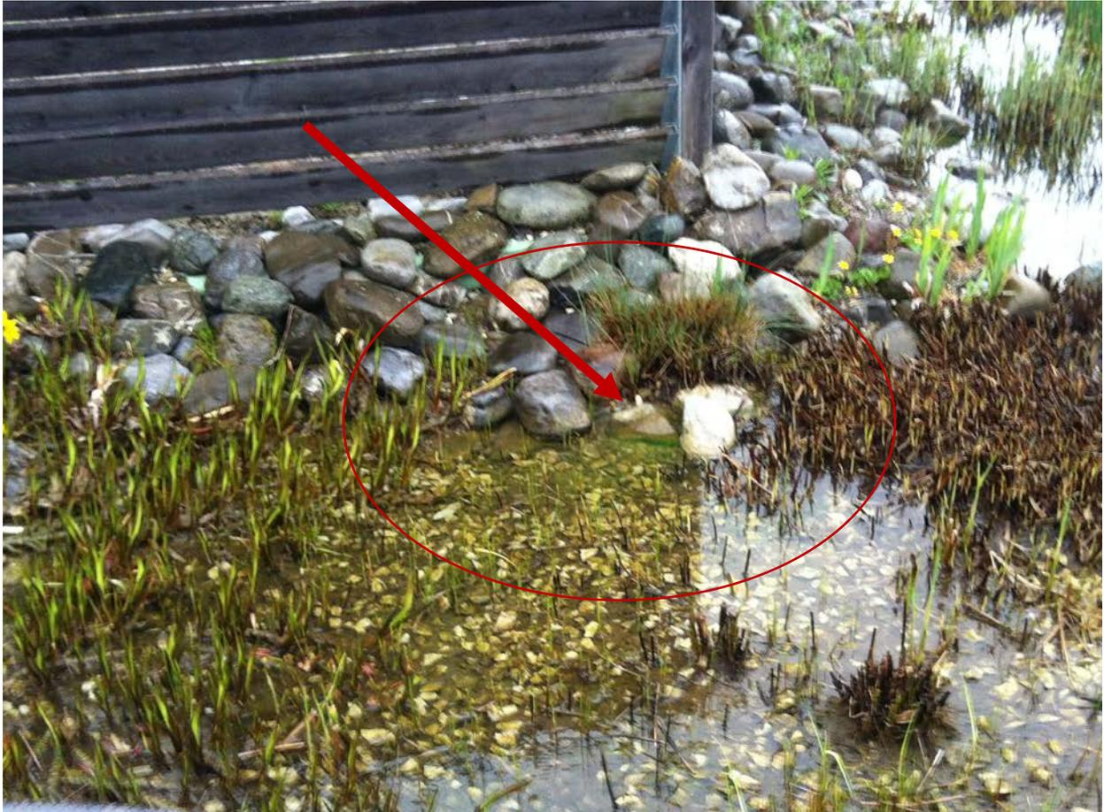
Abbildung 35: Filterfärbetest Pflanzenfilter mit «Kurzschluss» am Filterrand bei einer Schwimmteichanlage nach 10 Jahren.
