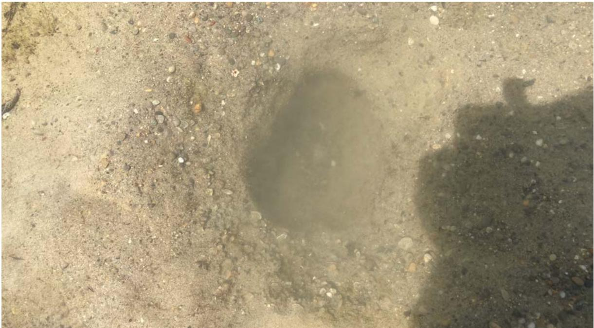
*Abbildung 7: Verhärtete, kolmatierte Substratschicht im Filter saugseitig, 08.07.2021*
