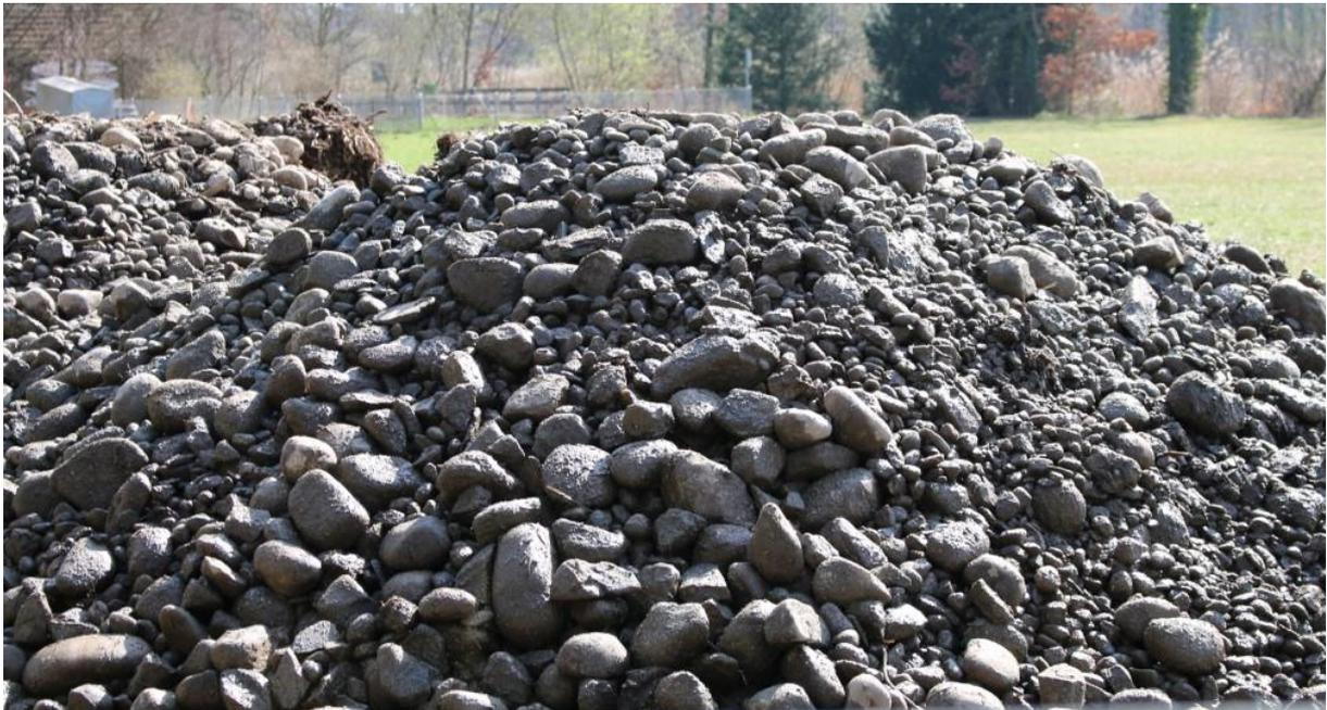
*Abbildung 38: Ausgebaggertes Filterkies nach 15 Jahren Filterbetrieb.*
