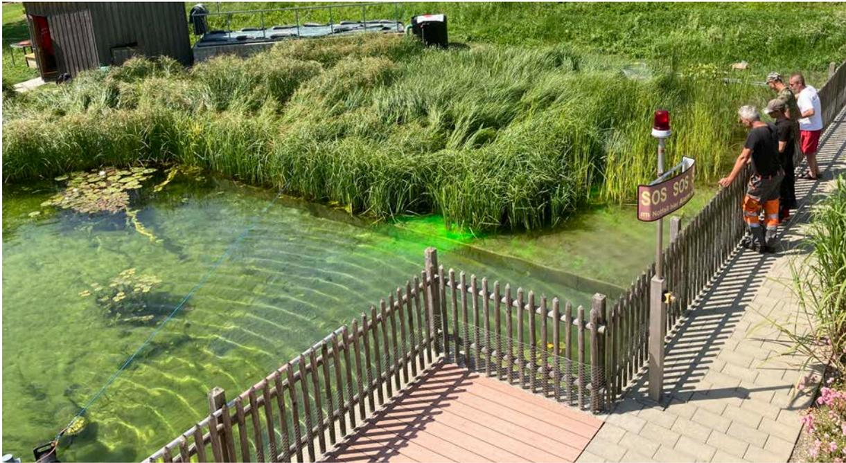
Abbildung 8: Färbetest in einem Filtersegment, eingefärbt über einen Beschickungsschacht, 21.07.2021
