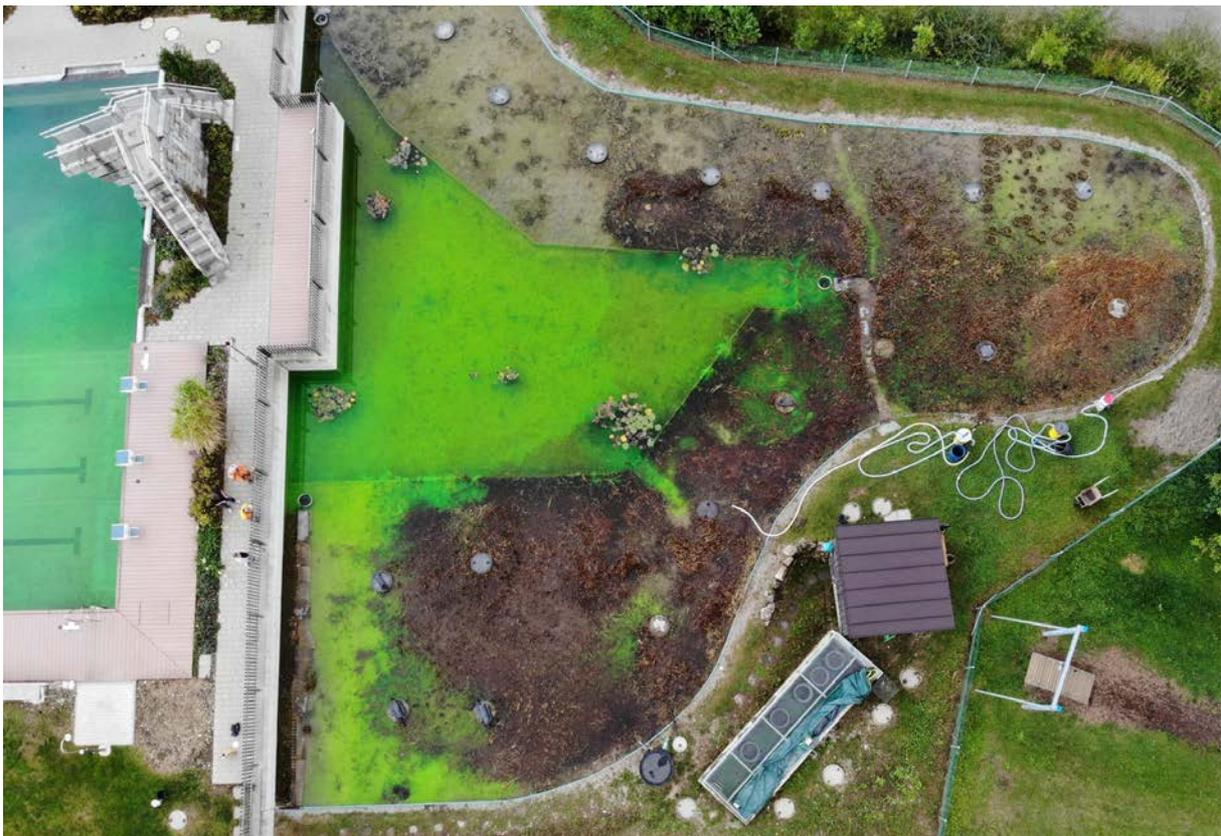
Abbildung 9: Färbetest mit Uranin im Pflanzensandfilter, vollflächige Anwendung über Einlauf-Sammelschacht, 16.09.2021
