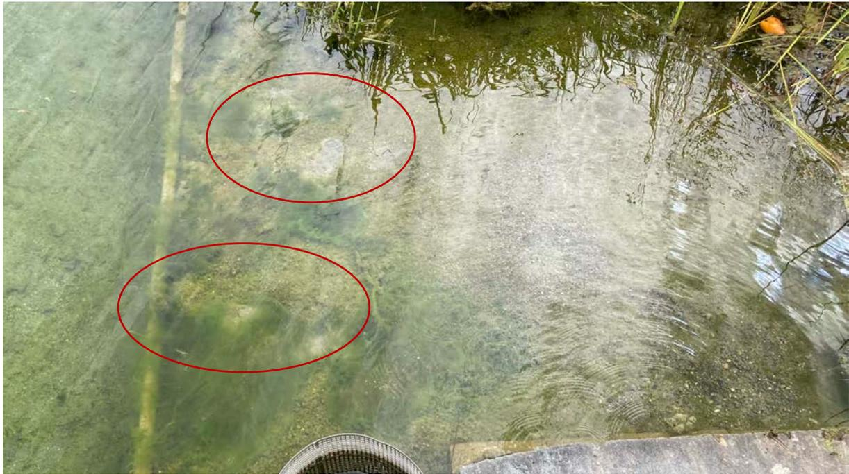
*Abbildung 10: Filterdurchschüsse druckseitig im vordersten Teil in Richtung Badebereich, 19.08.2021*
